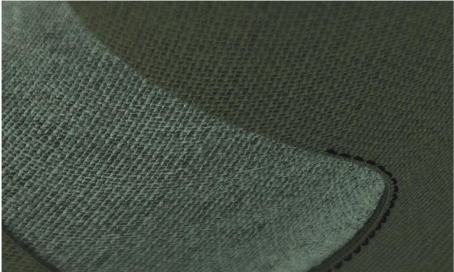
Figura 2: Campione di tessuto in canapa per a realizzazione della tomaia in associazione chimica.
