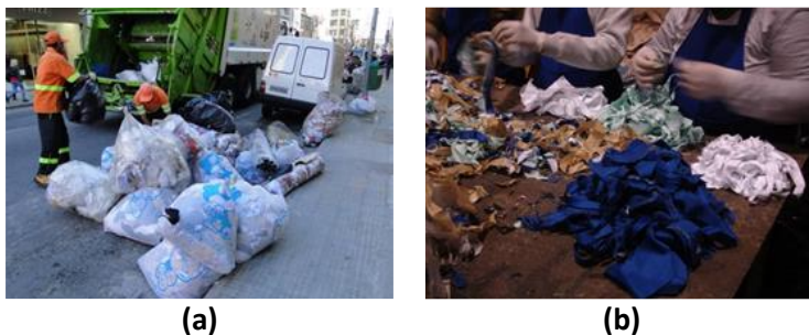
Figura 5 - Coleta teste realizada em julho de 2013 na principal rua do bairro Bom Retiro, Rua José Paulino: (a) resíduos coletados para estudo gravimétrico e (b) separação manual dos resíduos coletados.
