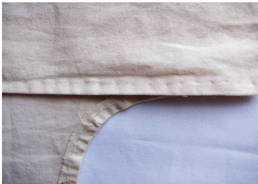
Figura 177 - Detalhe do acabamento do decote, com estreita fita, feita a partir da orelha do tecido. Foto: Isabel C. Italiano, 2017.
