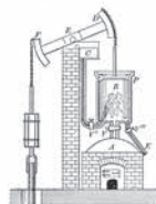
Diagrama da máquina a vapor de Newcomen.
