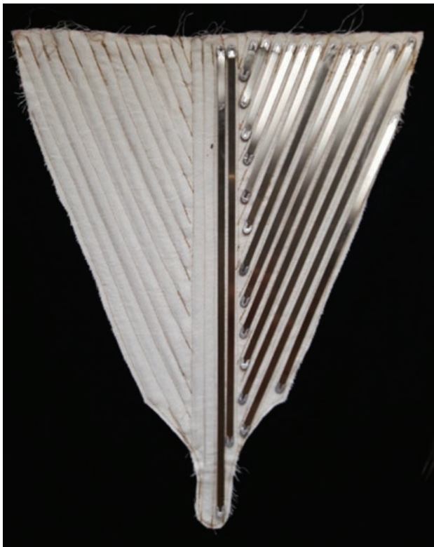
Figura 132 - Metade das barbatanas já preparadas para serem inseridas nas canaletas. Foto: Isabel C. Italiano, 2018.
