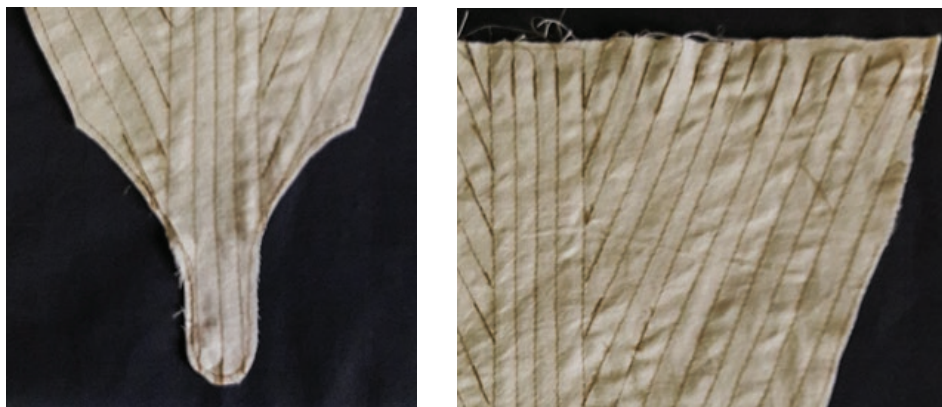
Figuras 130 e 131 - Detalhes das costuras das canaletas na base já preparada. Foto: Isabel C. Italiano, 2018.
