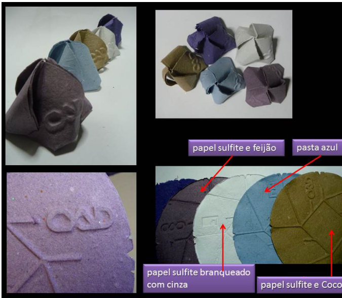
IMM.8.3: Diversi tipi di carte per imballaggi confezionati nell'atelier di fibre di cellulosa (UAM -X).
