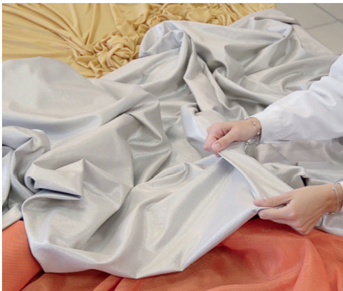
FIGURA 12.2: Tecidos com tratamento sol-gel, que confere diversas funcionalidades: propriedades hidrofóbicas, hidrofílicas, antimanchas, antichamas, entre outras. (NextMaterials, spin-off do Consorzio Interuniversitario Nazionale per la Scienza e Tecnologia dei Materiali (INSTM). Disponível em: http://www.nextmaterials.it . Acesso em dez.2017)
