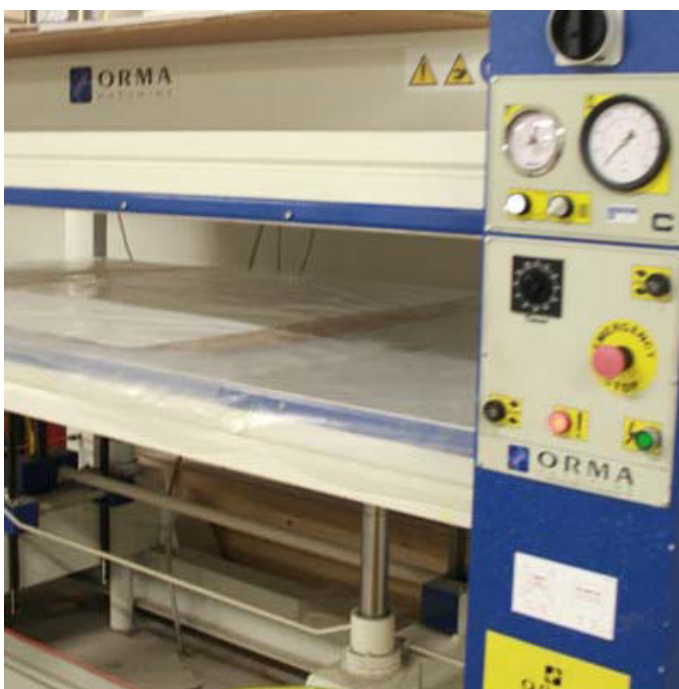
FIGURAS 6.1C, 6.1D: Fases do processo de produção efetuado no laboratório, respectivamente: secagem e prensagem final.
