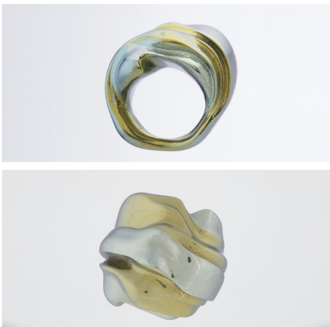
FIGURAS 16.3A, 16.3B: Anel em titânio de Michela Nosè, feito em SLM, polimento manual, coloração artística de M. P. Pedferri.
