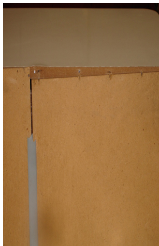
FIGURA 10.1: Porta de correr que tombou do guarda-roupas por conta do trilho de material plástico rompido.
