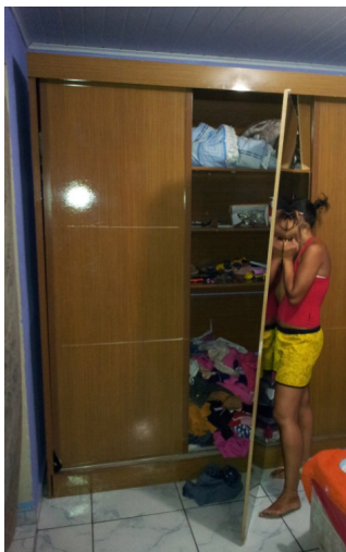
FIGURA 10.1: Porta de correr que tombou do guarda-roupas por conta do trilho de material plástico rompido.
